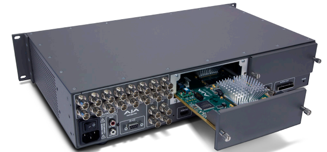
Corvid Ultra, panel trasero Se muestra con tarjeta opcional TruScale™ instalada
