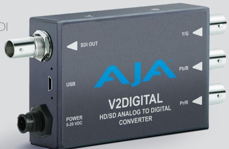
*Remarque : le V2Digital NE RÉALISE PAS de up- ni de down-conversion entre les résolutions SD et HD. Seule la conversion des signaux analogiques vers le numérique est supportée.*
