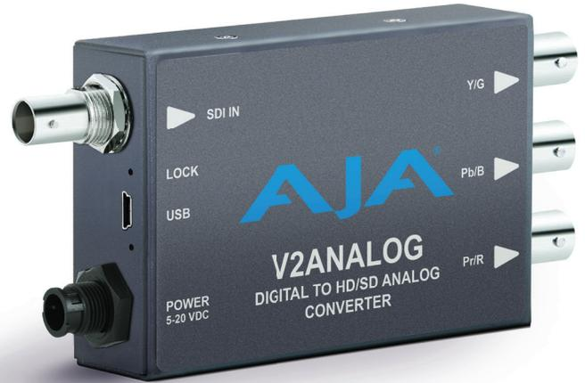
*Hinweis: V2Analog führt KEINE Aufwärts-/Abwärtskonvertierungen zwischen SD- und HD-Auflösungen durch. Nur die Konvertierung von digitalem zu analogem Signal wird unterstützt.*
